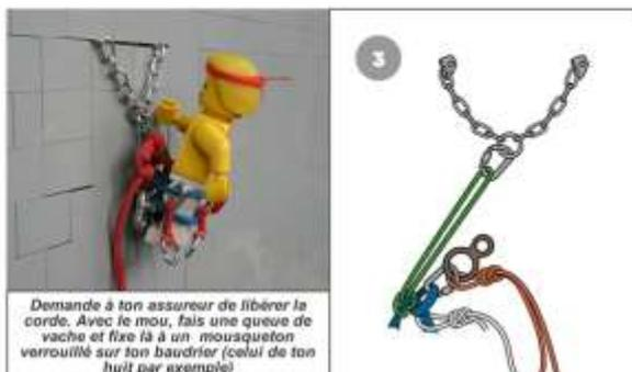
Demande à ton assureur de libérer la corde. Avec le mou, fais une queue de vache et fixe là à un mousqueton verrouillé sur ton baudrier (celui de ton huit par exemple).
